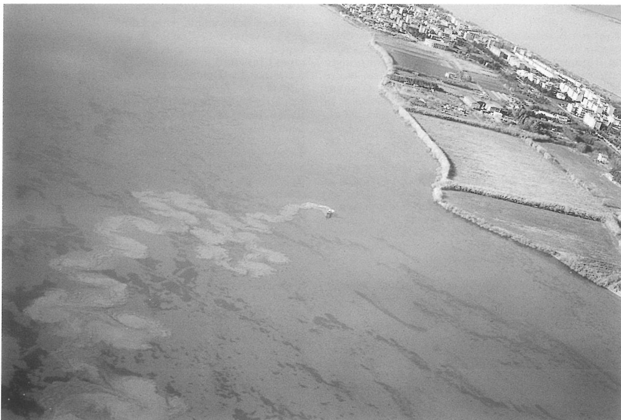
Fig. 4 - Natante raccoglieralghe in attività nella Laguna di Orbetello. La foto evidenzia il considerevole disturbo del sedimento durante il transito del battello.
