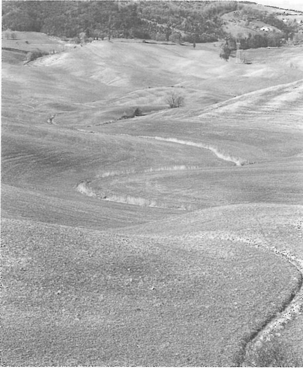
Fig. 3a - Paesaggio a biancane dopo la loro demolizione meccanica. Le ondulazioni che si possono osservare sullo sfondo e le chiazze più chiare sono la testimonianza della presenza delle biancane esistenti prima dello spianamento.
