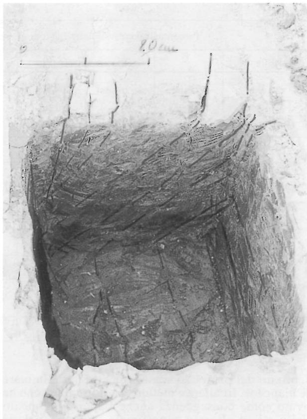
Fig. 4b - Tracce di sistemi di joints sulle pareti di un pozzetto scavato nella roccia madre, nell'area in esame.
