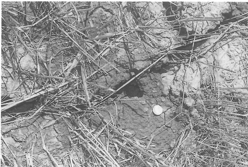
Fig. 5 - Fessure di contrazione nell'ara in esame.
