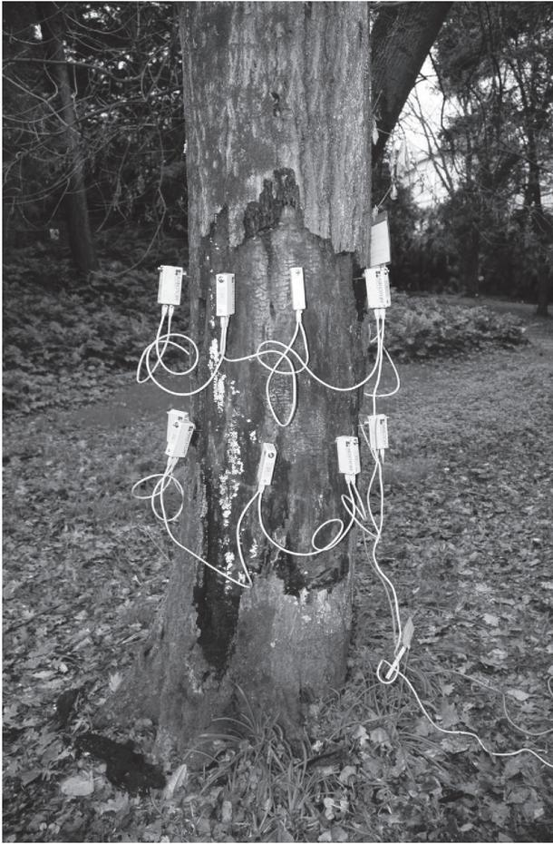
Fig. 1 - Sensori di un tomografo sonico applicati alla circonferenza di un albero, su due piani paralleli.
