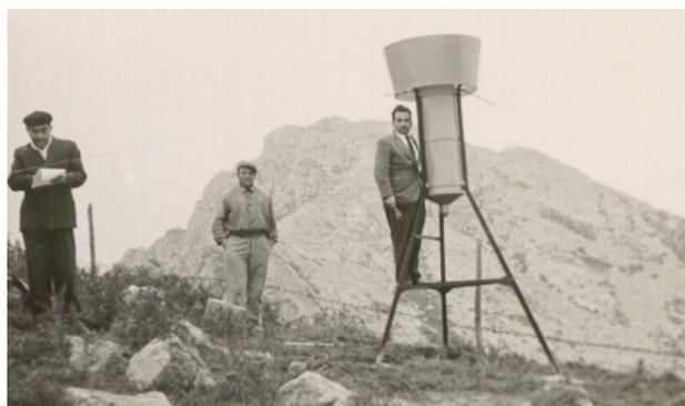
Figura 8. Pluvionivometro totalizzatore a bocca orizzontale presso la vetta del M. Capanne all’Isola d’Elba (fonte: Archivio fotografico dell’Ufficio Idrografico e Mareografico di Pisa - fine anni Cinquanta).
