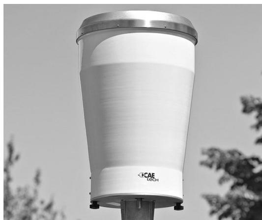
Figura 13. Pluviografo PG10 (CAE-Bologna) di accuratezza inferiore al 3% fino all'intensità di 800 mm/60 minuti.
