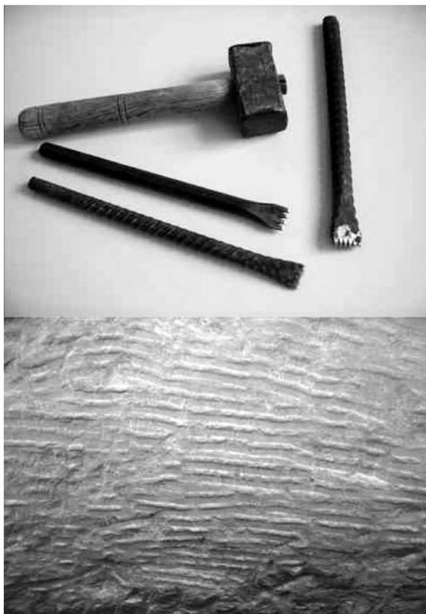
Fig. 11 - Strumenti in metallo (gradina e subbia) per la lavorazione della pietra. Sotto, esempi di lavorazione su marmo cipollino.
