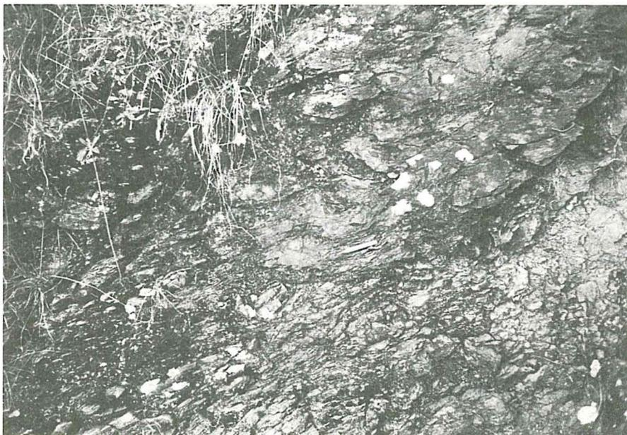
Fig. 23 - Contatto «molle» fra Peliti di Moglio milonitizzate (sopra) e marne dell'Elemento di Marmoreo (sotto); il mozzicone di matita al centro della fotografia è posto sul contatto. L'anastomosi fra i due termini è perfetta, con locali episodi di compenetrazione e amalgamazione (Castellaro, località Chiarretta).
