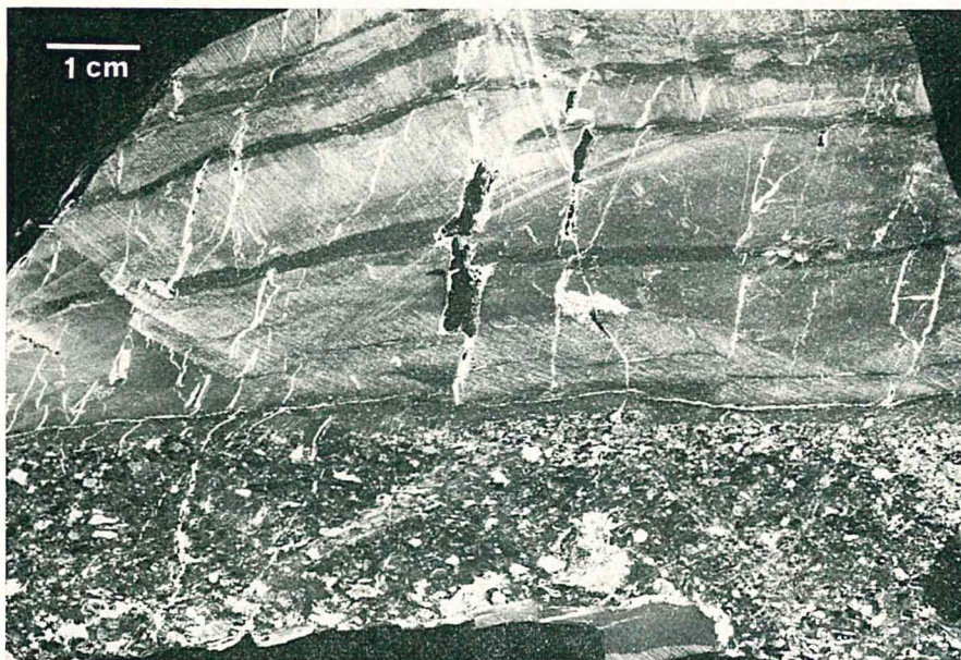
Fig. 1 - Sequenza torbiditica in uno strato del livello 2. L'intervallo basale gradato è costituito da detrito ofiolitico.
