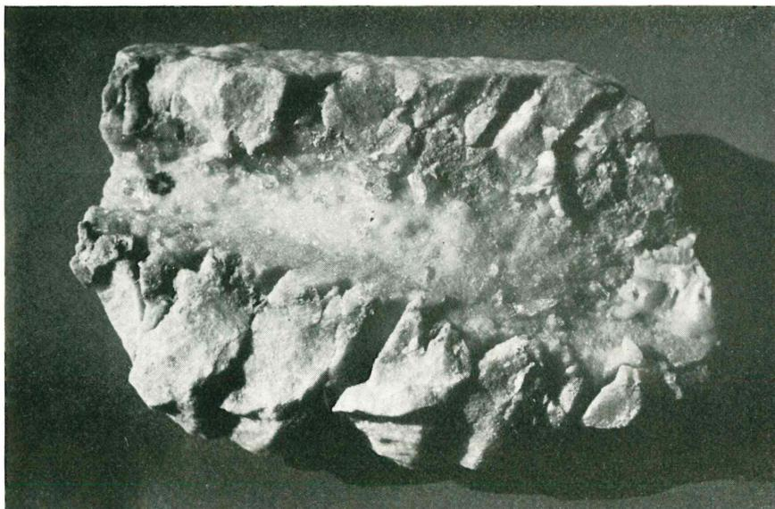
Fig. 4 - Campione conservato presso il Museo di Mineralogia della Università di Pisa. Sono evidenti le fratture, circa perpendicolari all'allungamento del geode.
