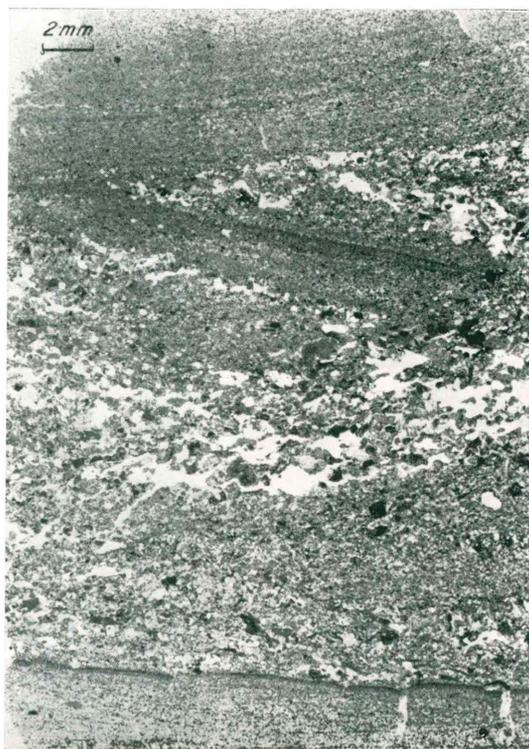
Fig. 10 - Aspetto microscopico di uno straterello calcarenitico. Si noti, in alto, la laminazione incrociata e, in basso, probabili fratture di disseccamento alla sommità di una lamina a grana più sottile.
