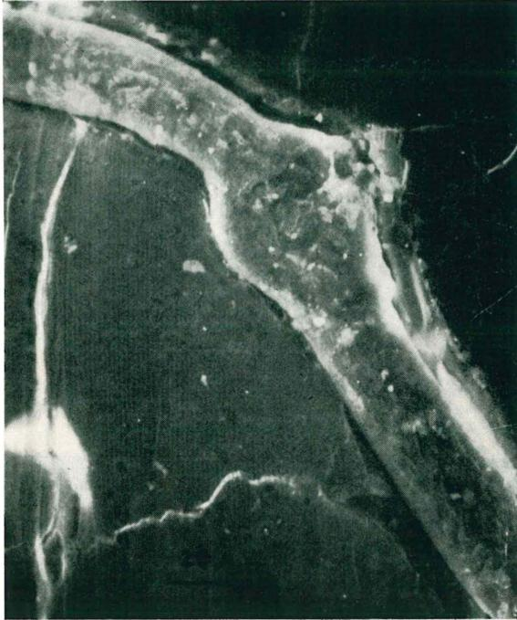
Fig. IIIa - Sbollature e rotture su filamento di cristallo (SEM).
