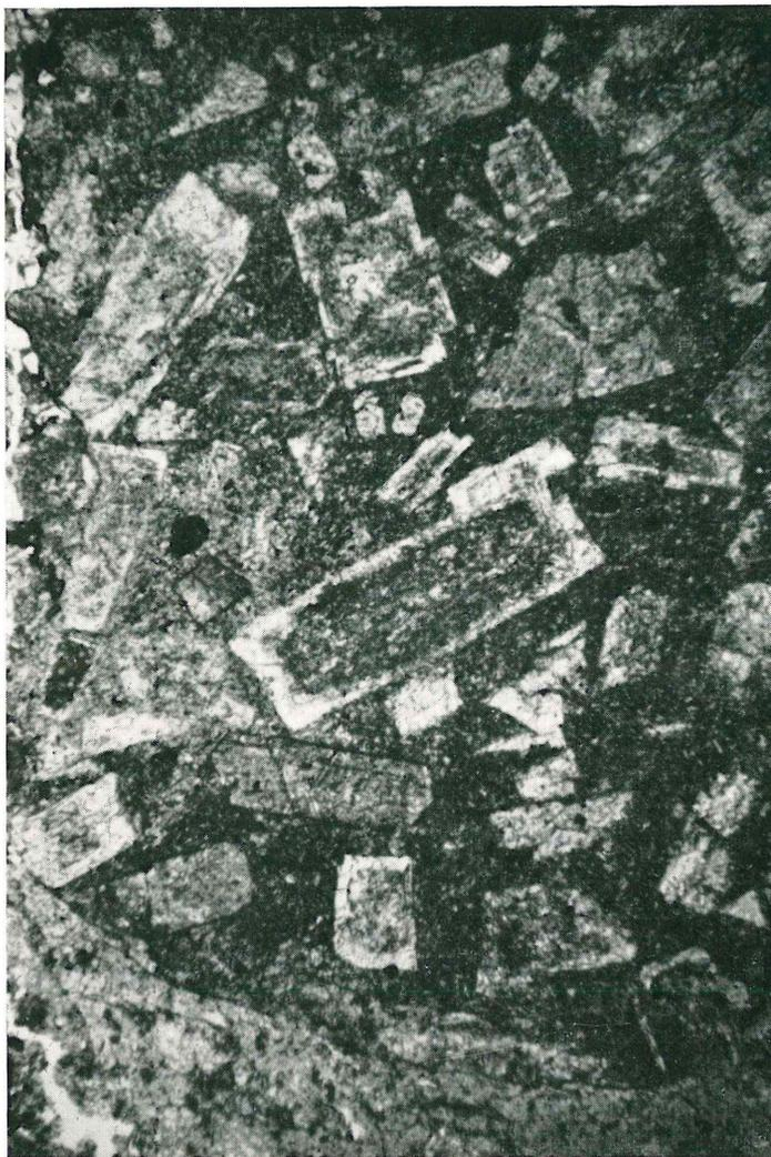
Fig. 2 - Frammento di vulcanite andesitica in sezione sottile (x27).
